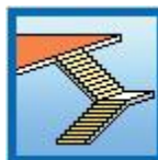
Două rampe drepte cu oprire completa
